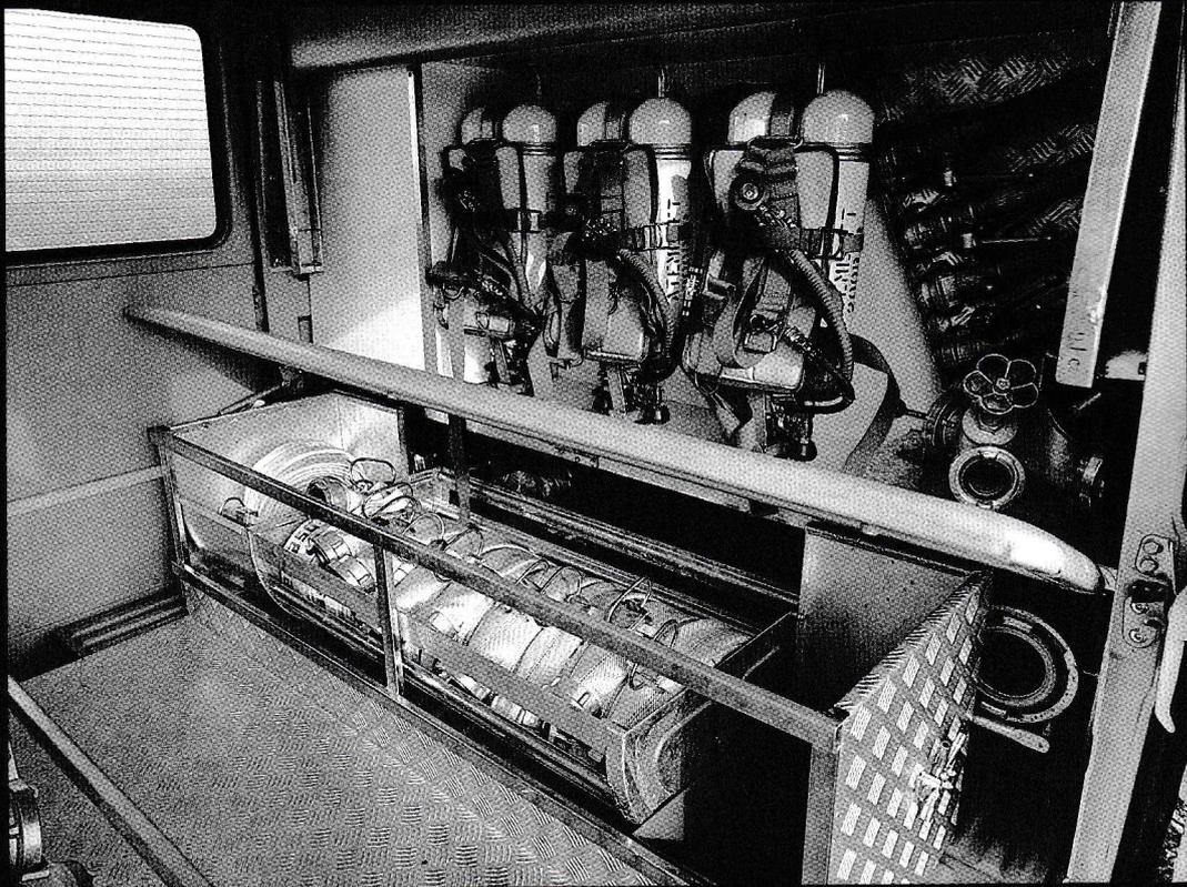
Neugestaltete, feuerwehrtechnische Inneneinrichtung für Langzeit-Verwendung, serienmäßig glanzverzinkte Profile, Auskleidungen, Bodenbeläge, Halterungen aus Leichtmetall (keine Lackbeschädigungen bei Ent- und Beladung der Ausrüstung), drehbare Aggregatschiene.
